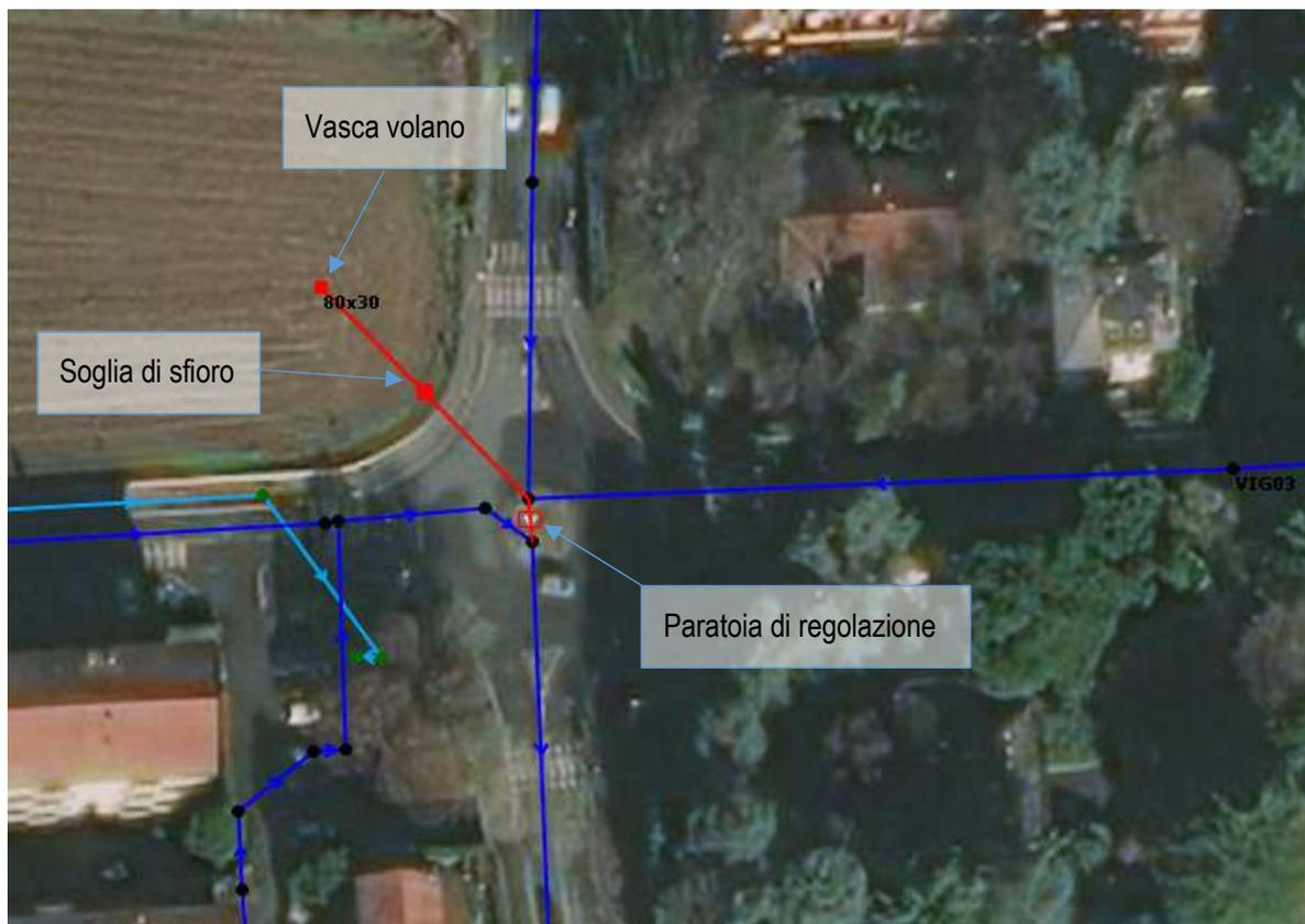
Figura 1 Schematizzazione vasca volano in Infoworks ICM
