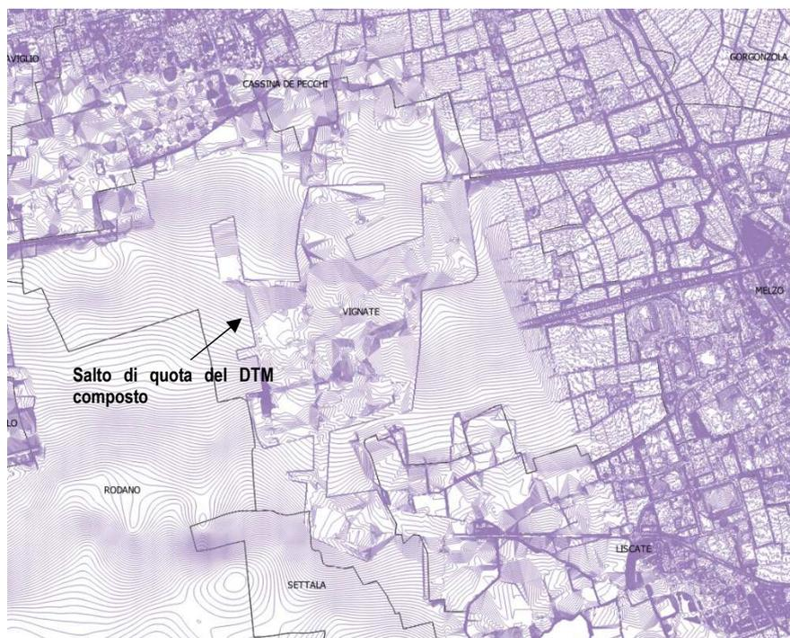
Figura 11 – Curve di livello DTM composto, caratterizzato da un brusco salto di quota
