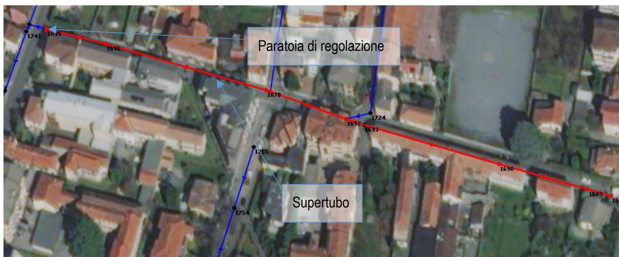
Figura 2 Schematizzazione laminazione in linea (supertubo) in Infoworks ICM
