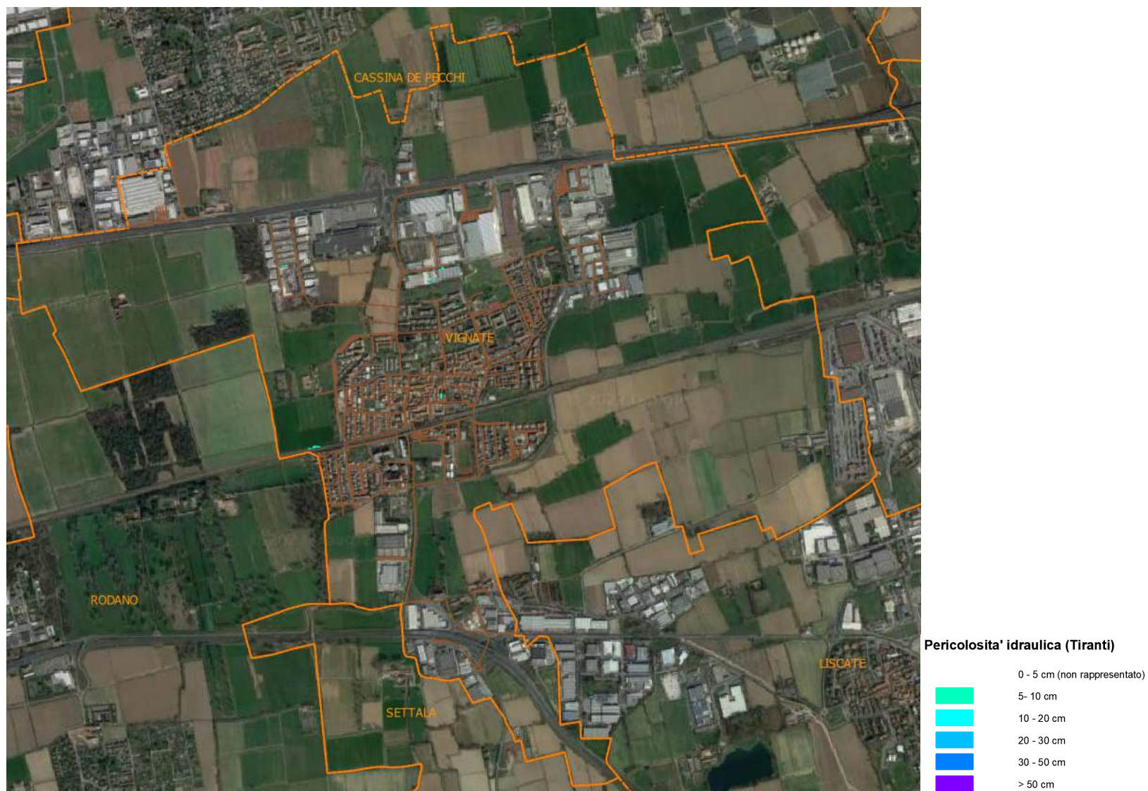
Figura 23 - Allagamenti stato di progetto T=10 anni
